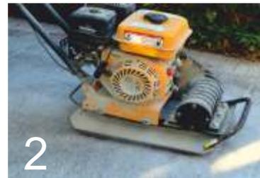
vollständig und gleichmäßig verdichten (Rüttelplatte, Gummihammer) und z.B. mit einem Spachtel die Verdichtung prüfen.
